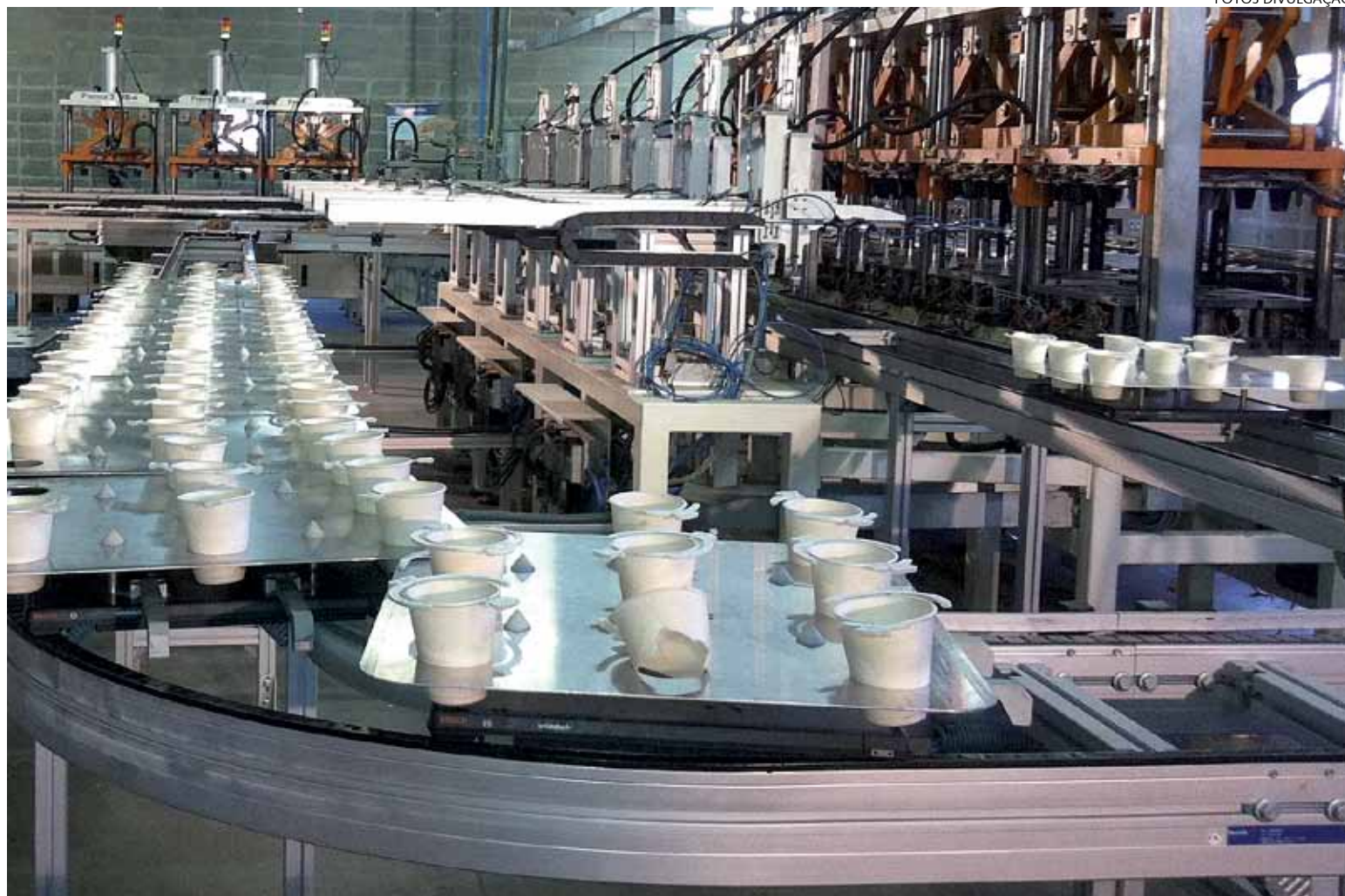
Durante o processo de fabricação de um copo compostável, o consumo de água é de apenas 8ml, contra 400ml na produção do copo de plástico
